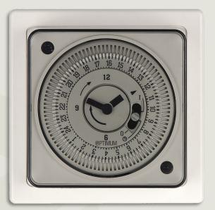
OP-SBST IS A CAPTIVE-TAPPET 24-HOUR TIME SWITCH. EACH TAPPET OPERATES FOR 15 MINUTES. THE TIMER IS SUITABLE FOR INSTATLLATION ON A SURFACE OR IN-WALL PATTRESS BOX. THE 24 HOUR DIAL CONTROLS A VOLT-FREE CHANGEOVER SWITCH, WITH A RESISTIVE RATING OF 16 AMPERES.
